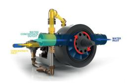
Il flusso di acqua passa attraverso il motore idralico FIREMIKS. Questo genera la rotazione del motore trasferendo il moto alla pompa attraverso il giunto di accoppiamento. Il liquido concentrato é pompato sulla uscita del motore idraulico, dove avviene il dosaggio.
