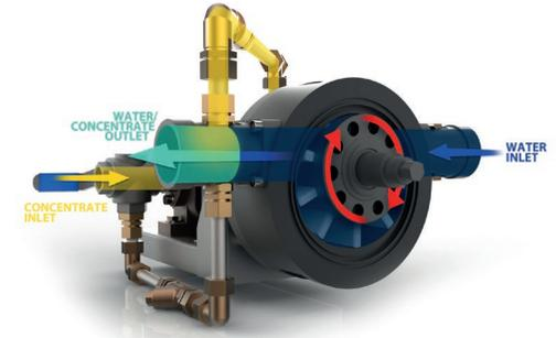
El flujo de agua pasa por el motor de agua FIREMIKS. Esto genera un movimiento circular del rotor el cual es transferido a la bomba de concentrado sobre el acoplamiento directo. El concentrado de medios de extinción es inyectado en la salida de agua del motor en donde se mezcla la solución de concentrado con agua.
